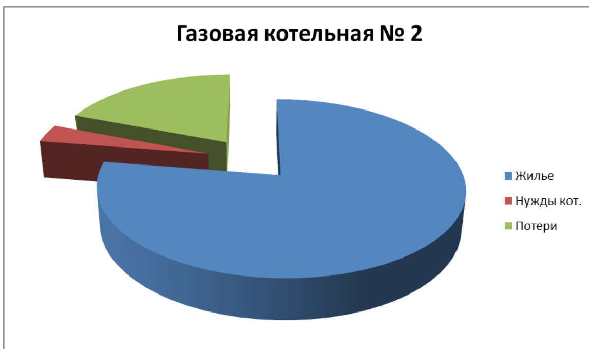
Рисунок 2. Структура потребления тепловой энергии, выработанной газовой котельной № 2 ст. Просница
