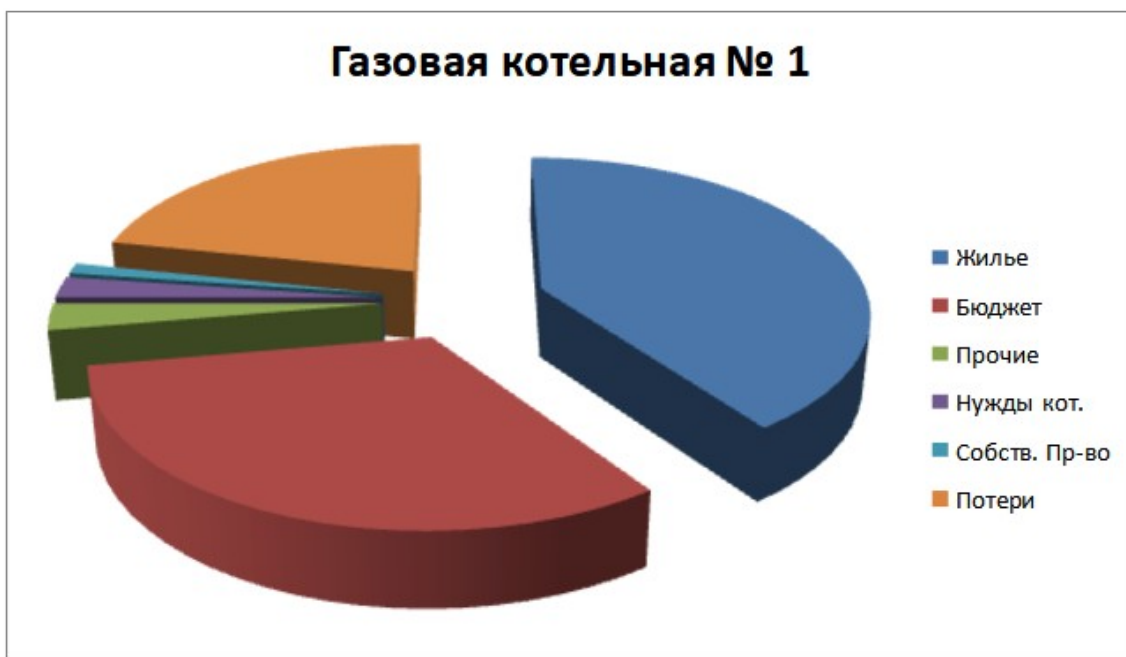
Рисунок 1. Структура потребления тепловой энергии, выработанной газовой котельной № 1 ст. Просница
